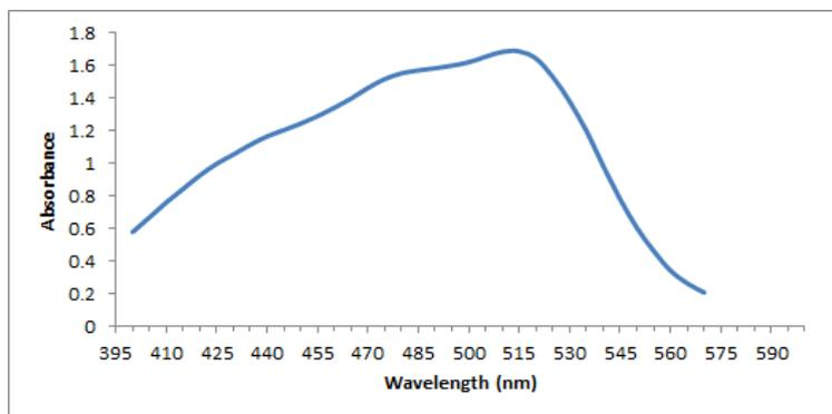
Fig. 5. Absorption spectrum of ferriin-Trp ion pair.
