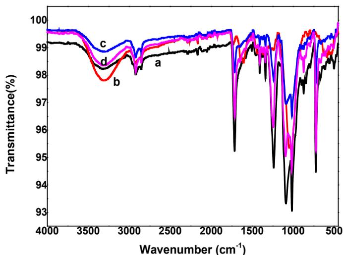
Fig. 4. FT-IR spectra of blank furniture textile fabrics (a) GMPP (b), F-CH-GMPP20(c), F-CH-GMPP70 (d) .
